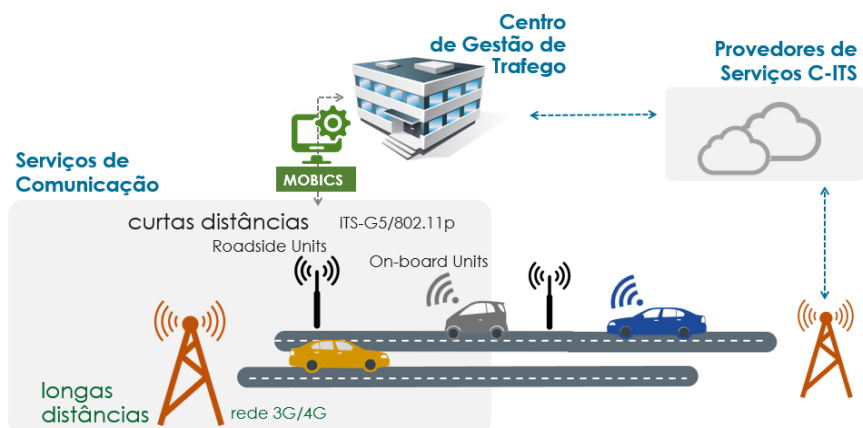
Figura 8. Arquitetura da estrutura C-ITS da A-to-Be
