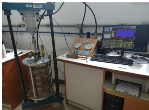
Fig.5. Ensaio Triaxial de Carga Repetida
