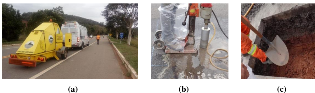
Fig.1. Procedimentos realizados em campo: (a) Levantamentos deflectométricos, (b) Extração de corpos de prova revestimento asfáltico, (c) poços de sondagem – coleta dos materiais.
