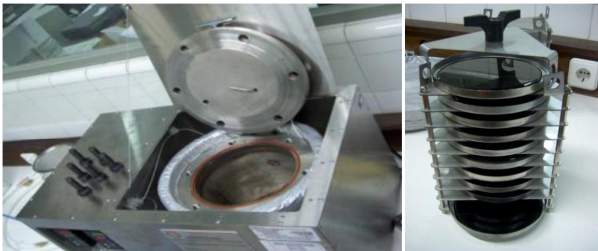
Fig.2. PAV (esq.) e recipientes com material para envelhecimento (dir.)
