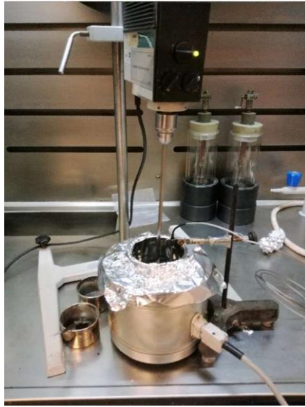
Fig.1. Fabrico do mastique betuminoso
