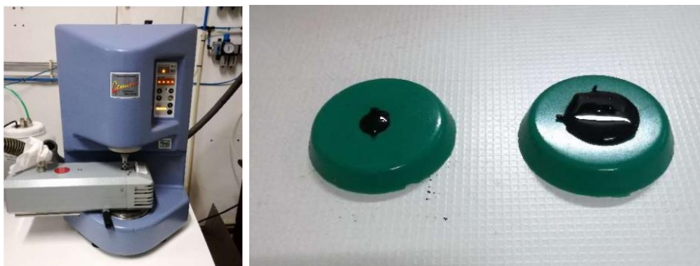
Fig.3. Reómetro rotacional (esq.) e moldes de silicone com provetes (dir.)
