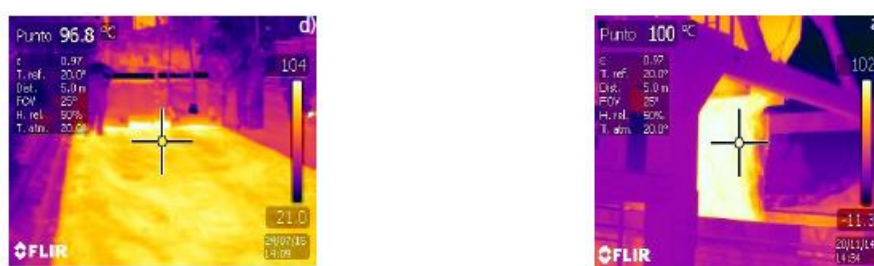
Fig. 7. Termografias durante o espalhamento e a fabricação
