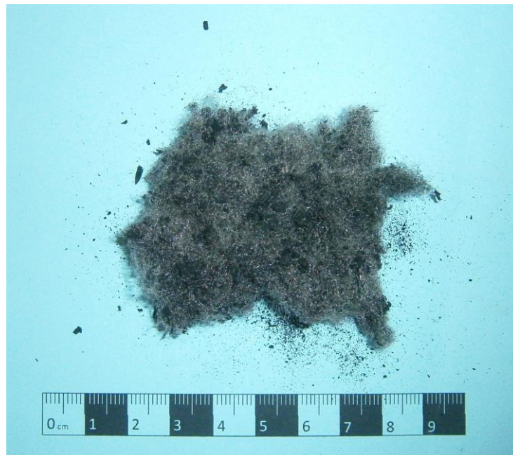
Fig. 3. Fibras têxteis de pneu, fluff
