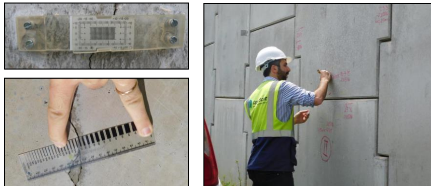
Fig.3. Monitorizações específicas em muros de suporte da A24
