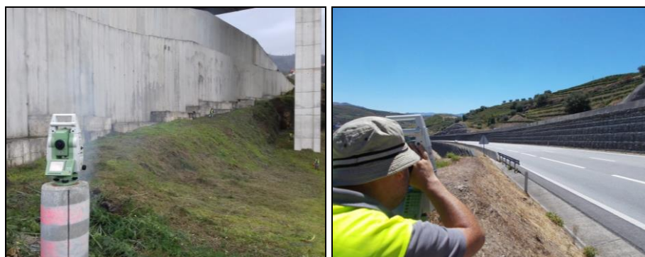
Fig.4. Monitorizações com equipamentos topográficos em muros de suporte da A24
