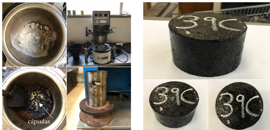
Fig.3. Fabrico da mistura betuminosa com cápsulas de alginato de cálcio e provetes finais obtidos
