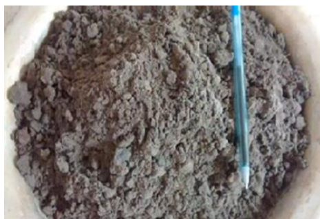
Fig.2. Amostra do resíduo de minério de ferro utilizado neste trabalho
