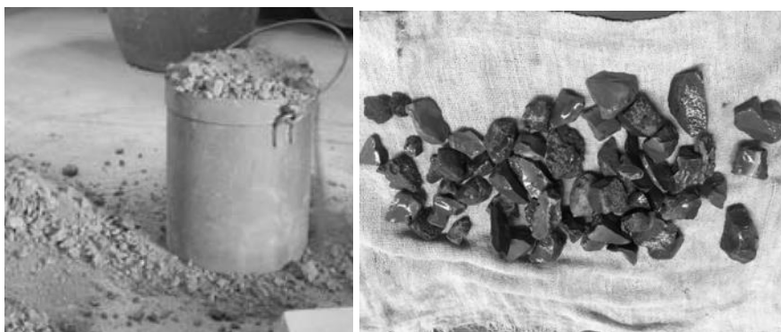
Fig.3. Diferença de forma e superfície: à direita, escória de aciaria; à esquerda, escória de FeSiMn [23]
