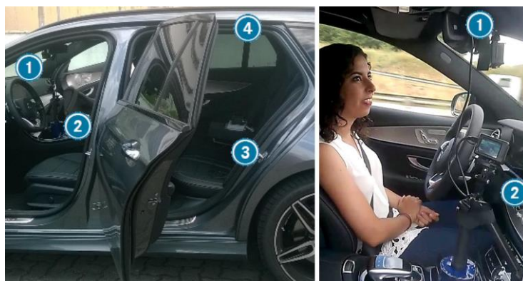
Fig.1. Equipamento instalado: Esquerda – câmara de enquadramento frontal (1) e da interação do condutor (2), datalogger (3) e antena GPS (4); Direita – Posicionamento das câmaras de vídeo.
