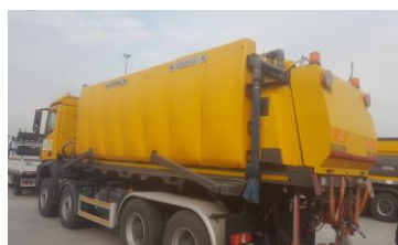
Fig. 5. Equipamento pesado de espalhamento de salmoura
