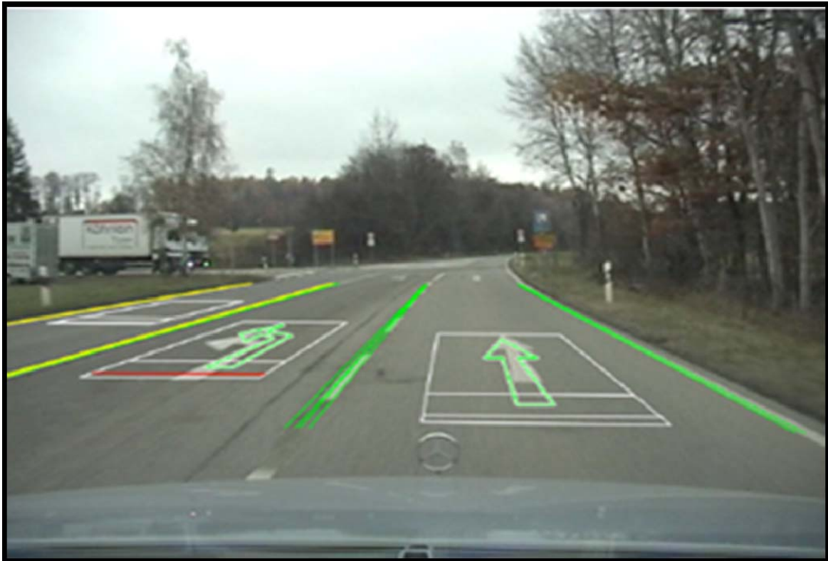
Figura 3 – Leitura do sistema de marcação rodoviária pela viatura autónoma [4].
