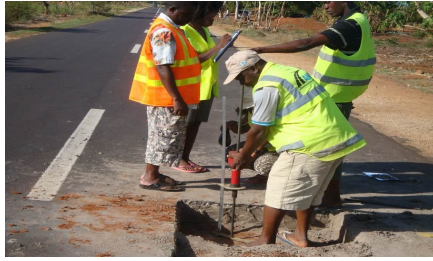
Fig. 3- Teste de DCP levado a cabo numa secção de teste
