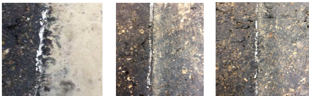
Fig. 4 Lajeta BBR2 antes durante e após aspiração (ensaio 40°C)
