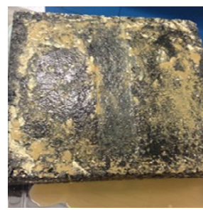
Fig. 6 BBR1 após lavagem (ensaio a 40°C)
