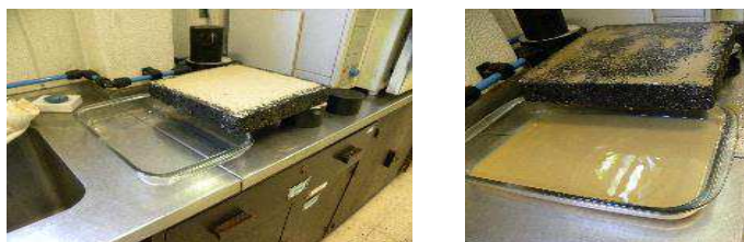
Fig. 3. Lajeta ensaiada: à esquerda antes e à direita após a lavagem
