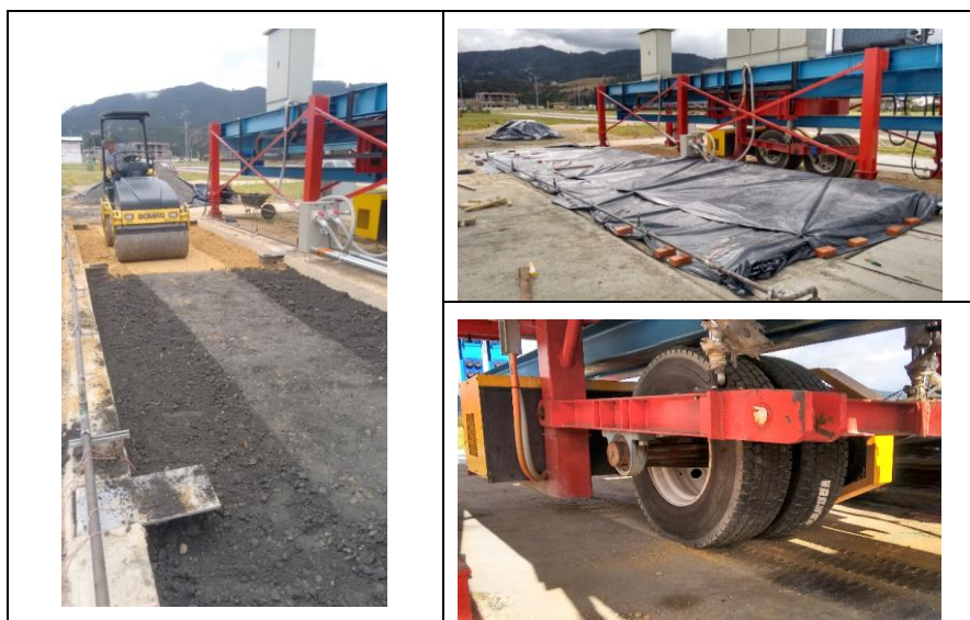
Fig.5. Realização dos ensaios de fadiga na UMNG
