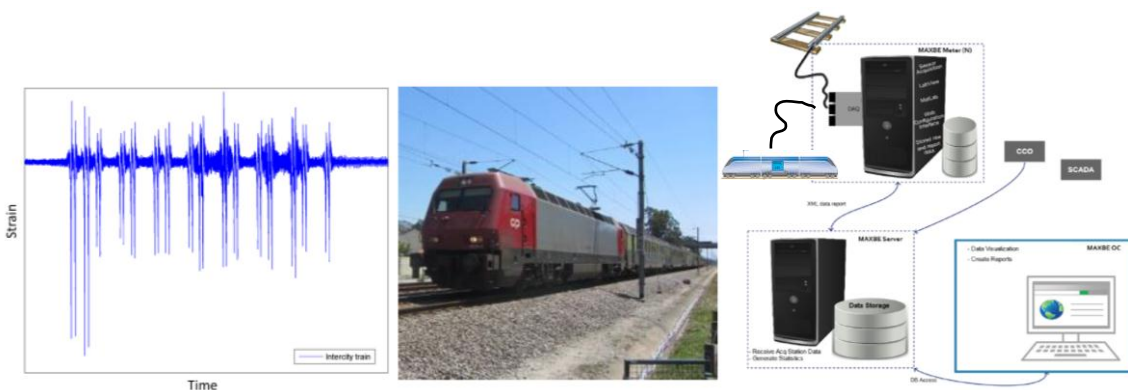
Fig. 4. Dados adquiridos em ensaio real e esquema geral do sistema [2]
