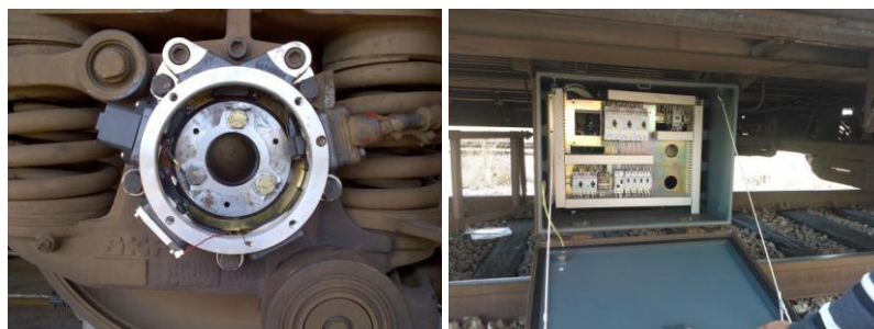
Fig. 2. Sistema de monitorização instalado na caixa de eixo e sistema de aquisição de dados [1]
