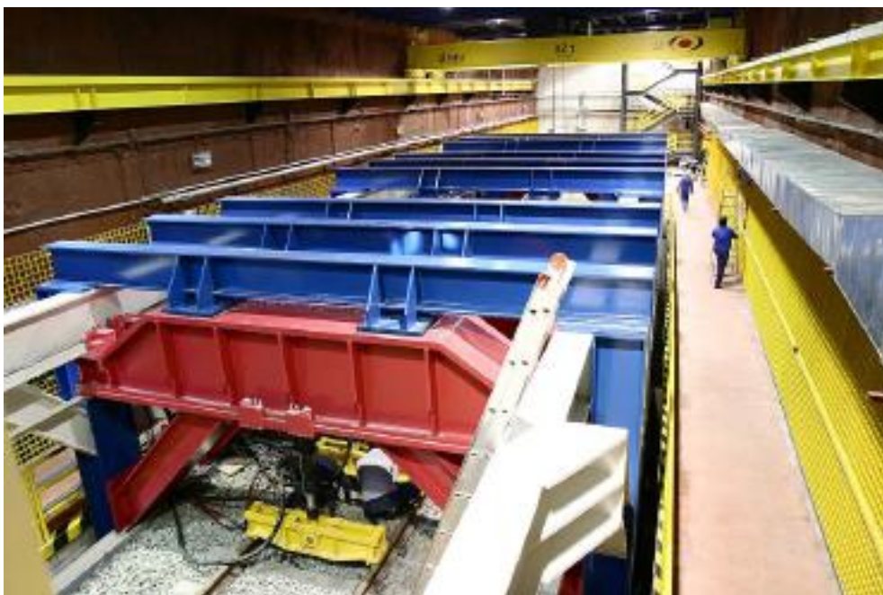
Figura 5. Caixão de ensaio de plataformas ferroviárias do CEDEX.
