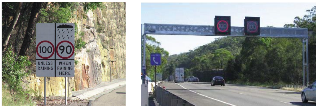
Fig. 1. Exemplos de aplicação/sinalização de VSL: (a) SVSL; (b) DSL [5]
