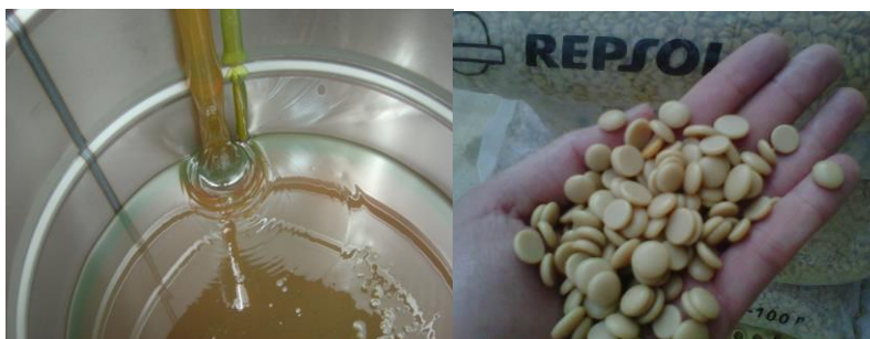
Figura 2. Betumes sintéticos de aplicação em líquido e sólido
