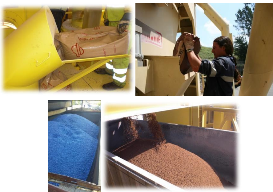
Figura 6. Introdução do ligante e pigmento(acima) e descarga de mistura (abaixo).
