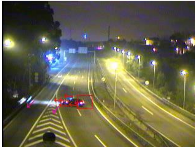
Figura 11: Exemplo de detecção de contramão através do DAI
