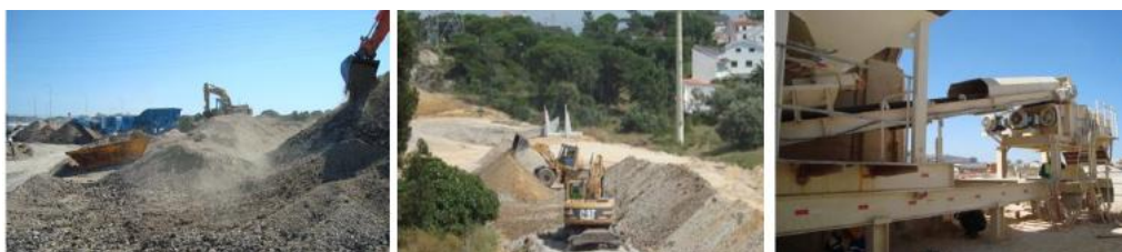
Fig.8. Mistura e correção dos agregados britados obtidos, com pá/giratória, ou em "central"
