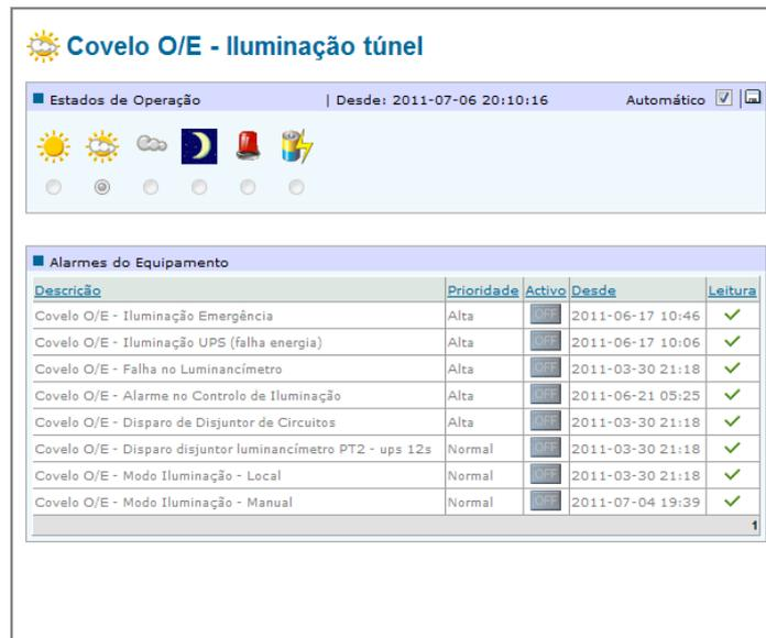
**Figura 2.** Exemplo da interface de operação uniforme para elementos do túnel
