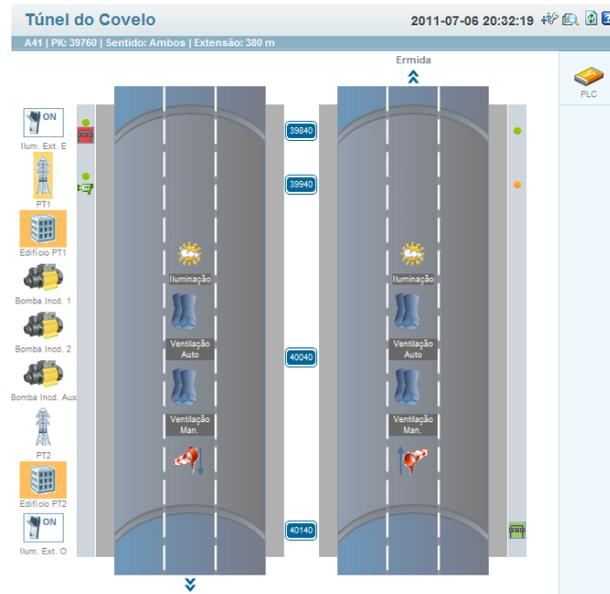
**Figura 1.** Exemplo do sinóptico do túnel do Covelo no ATLAS
