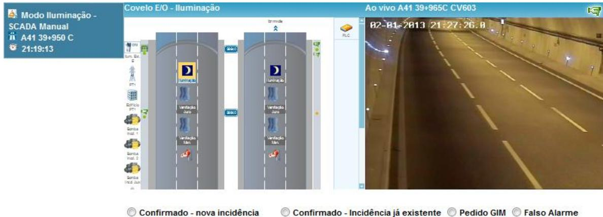
**Figura 7.** Exemplo de uma sugestão de incidência para um túnel.
