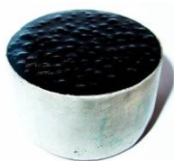
Fig. 2. Aspeto heterogéneo do betume modificado com SBS granulado (má digestão no betume)
