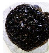
Fig. 3. Partículas de ABS granulado não digeridas no betume após filtragem do betume modificado
