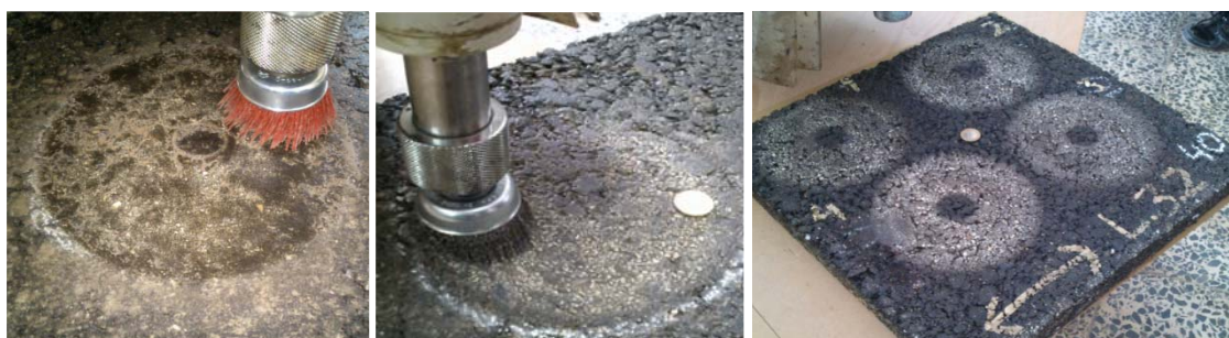
Fig.1. Processo de desgaste com catrabuchas de náilon e de aço e efeito produzido após ação de desgaste
