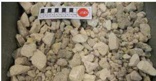
(c) Mistura de 70% de ABGE calcário com 30% de mistura betuminosa fresada
