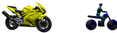
Fig.7. Modelo do motociclo sem condutor e modelos multicorpo do motociclo e condutor.
