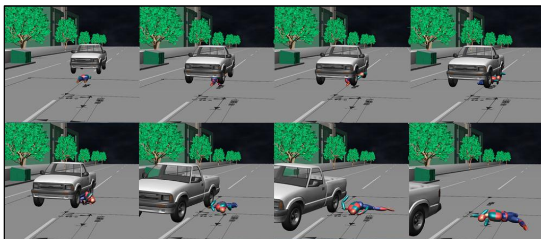
Fig. 9. Simulação computacional de atropelamento com peão caído na via.
