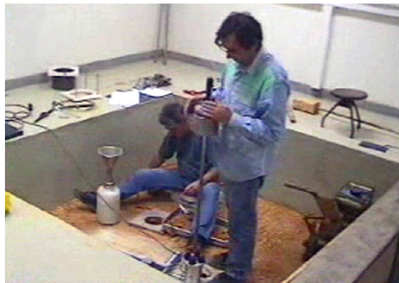
Fig.4. Aspetto do modelo físico e dos ensaios realizados durante a construção das camadas de agregado calcário.
