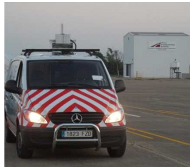
Fig.6: Fonte: Avaliação das medidas de retrorreflexão da sinalização através do sistema de Inspeção Visual de sinalização e Painéis (VISUALISE) .TTI, JULHO 2012.
