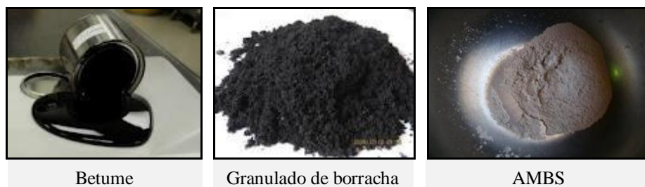
Fig 1. Constituintes da RAR: betume, granulado de borracha e AMBS
