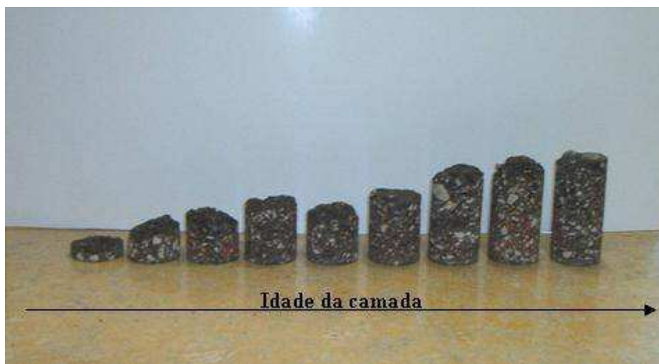
Figura 11 – Evolução do teor em água da mistura reciclada com a idade da camada
