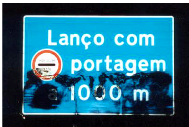
Fig. 9 a – efeito de limpeza com material abrasivo
