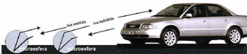
Fig. 1- Efeito de Retrorreflectorização
