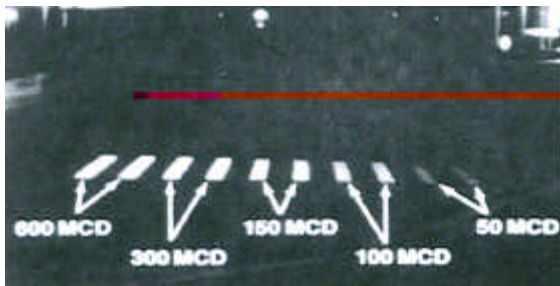
Fig. 2- Coeficiente de Retroreflectividade
