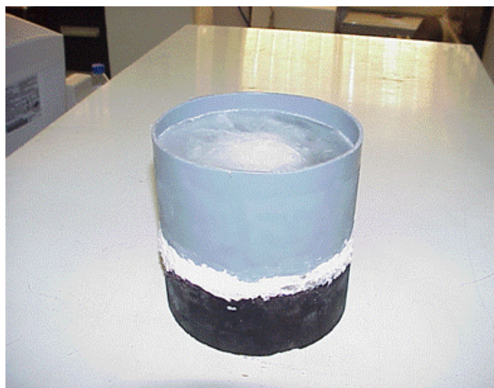
FOTO 1: Probeta antes de ensayar. Aglomerado + slurry + placa de hielo
