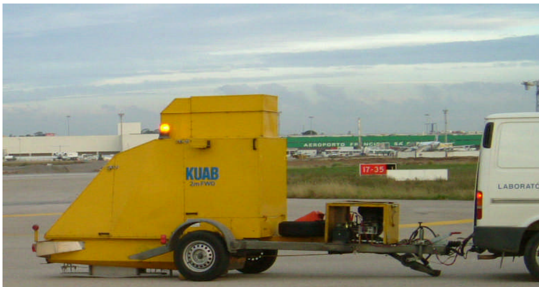
Figura 1 – Deflectómetro de impacto do LNEC
