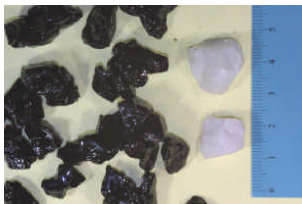
Figura 2 – Adesividade nas partículas de quartzo
