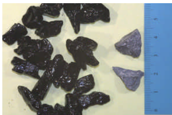
Figura 1 – Adesividade nas partículas de grauvaque
