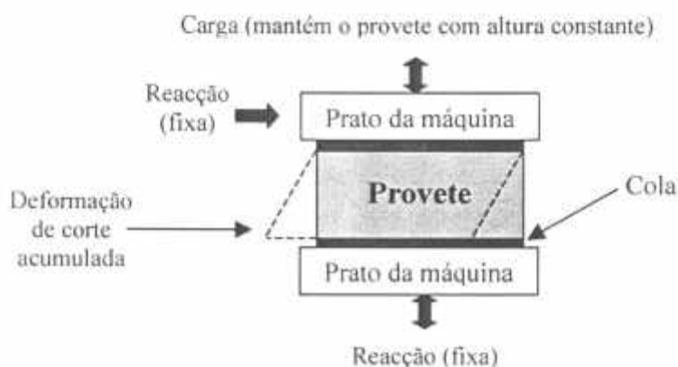
Figura 8 – Esquema do ensaio de corte a altura constante
