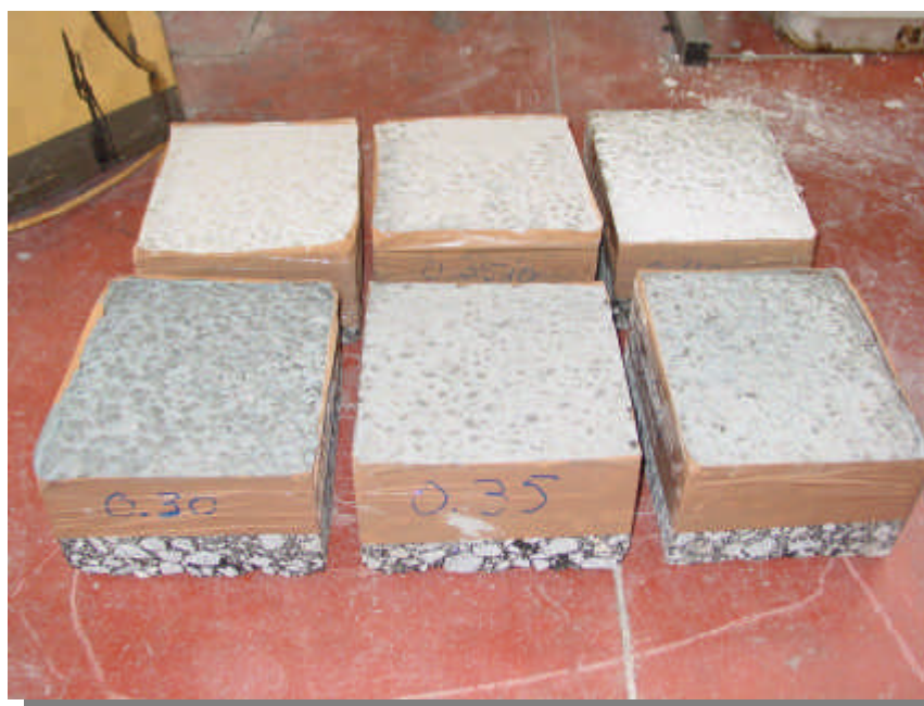
Figura 3 – Lajes preenchidas com calda de cimento
